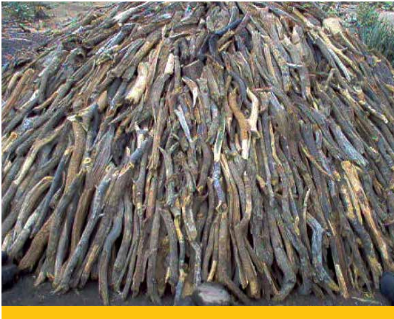
Horno circular antes de tapanlo para producción artesanal de carbón. Tomado de Alzuru, A. I. (2005) Citado previamente.
